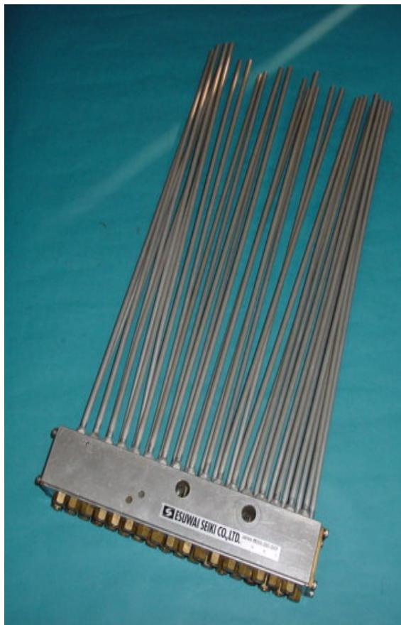
スプレーノズルをアルミに変更 SN-6AT 2.5kg
